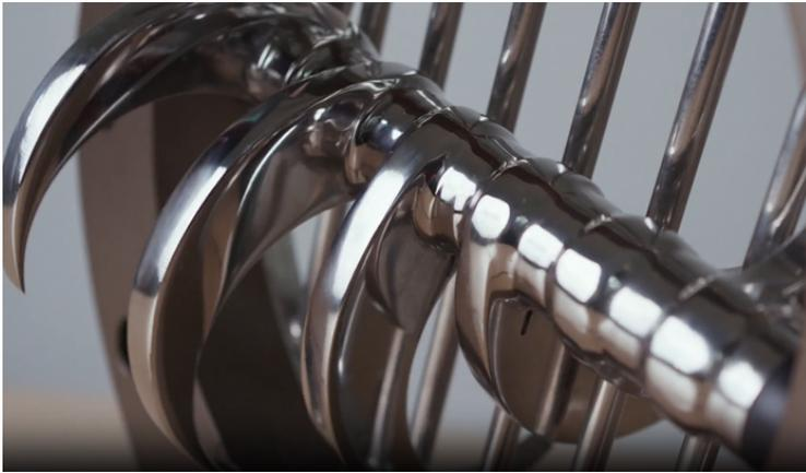
Il rompigrumi è uno strumento progettato per semplificare la gestione di materiali che tendono a formare grumi o aggregati.
